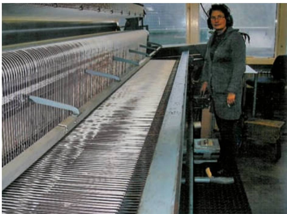
Lindemann bindemaskin, 250 masker dyp. Ca. 15 slag i minuttet. Maskeleggen/omfaret kan justeres etter behov, fra 12–150 mm. Her viser fronten på maskinen med skytlene/undertråden. Olaug Ferkingstad styrer maskinen.
