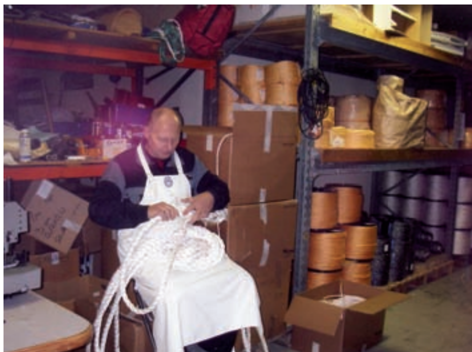
Sigurd L. Medhaug spleiser stropper (maskelegger). Maskene i de store trålene er blitt så store at notlinen ikke kan lages på maskin. Maskeleggene blir derfor spleiset for hånd.
