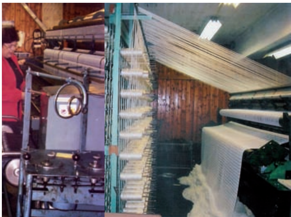
Gunn Hemnes. Trådgalleriet står bak bindemaskinen. Tråden kan ha en lengde på opp til 2000 meter. Denne tråden går fram til fronten av maskinen og blir knyttet sammen med undertråden.
