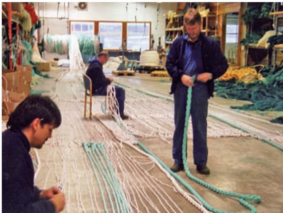
Kai Eriksen, Liold Steven Knutsen og Terje Rasmussen spleiser masker til en frampart til en ny trål hvor hver hel maske er 25,60m.
